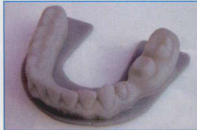
Abb. 1: Aus Zeit- und Kostengründen werden die Zahnkränze hohl, in minimaler Wandstärke – etwa 0,7 Millimeter – passend zur K'volution LC digital Modellbasis von Dental Kiefer gedruckt (hier 3D Systems). Die geprinteten Zahnkränze sind mit passenden Bohrungen und einer komplett planen Auflage zur Modellbasis programmiert und dann konstruiert.
