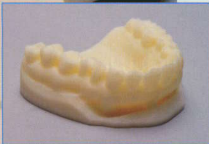
Gipsküche ade – generativ hergestelltes Zahnmodell
