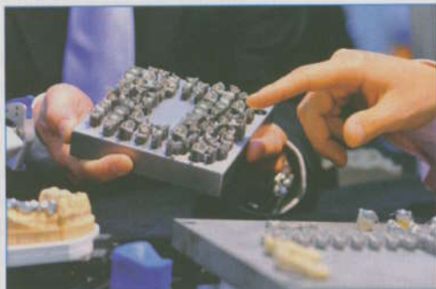
Lasergesinterte Kronen- und Brückengerüste
