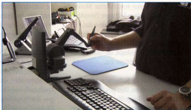
Mit dem Modelliergriffel werden dreidimensionale Strukturen „fühlbar“.
