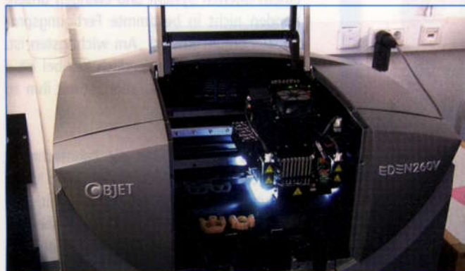
Additive Fertigungsverfahren haben Eingang in zahntechnische Arbeitsabläufe gefunden. Mit 3-D-Printern werden die Modelle schichtweise aufgebaut.
